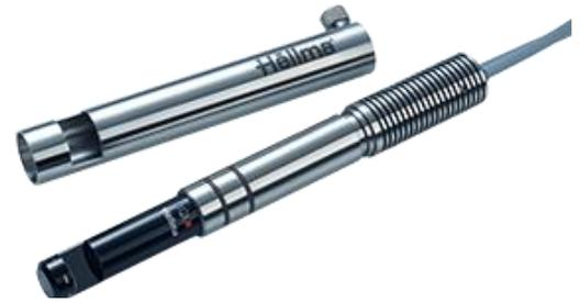
Die **Excalibur Lab** ist eine klassische Tauchsonde zur Anwendung in Laboren oder für Online-Messungen im Technikum. Sie zeichnet sich durch eine hohe Transmission und hohe Flexibilität aus. Das optische Material aller Laborsonden ist Quarzglas.
